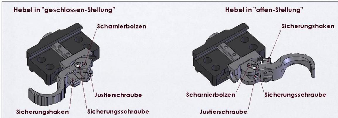
ERATAC®-Sicherheitshebel ermöglichen einfaches, schnelles und wiederholgenaues Auf- und Absetzen von Zielfernrohren und Zusatzgeräten auf Picatinny-Schienen. Die Einstellbarkeit des Hebels ermöglicht sicheren Halt auch auf Schienen, welche nicht dem Mil-Std. 1913 entsprechen. Die Stellung des Hebels ist frei wählbar.
